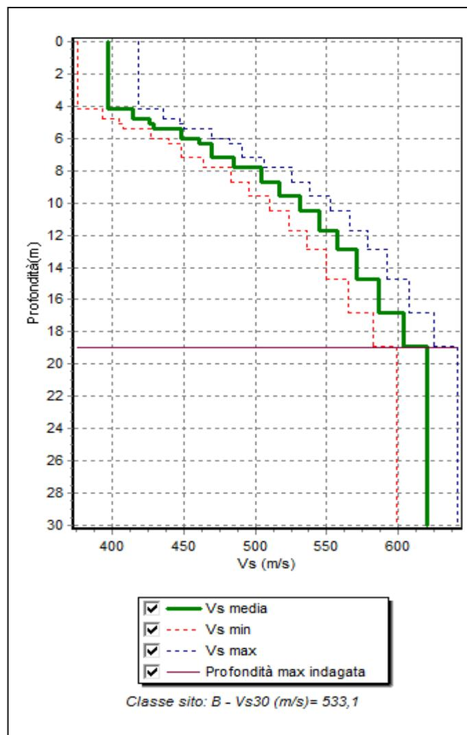
Figura 4: Profilo Vs numerico
